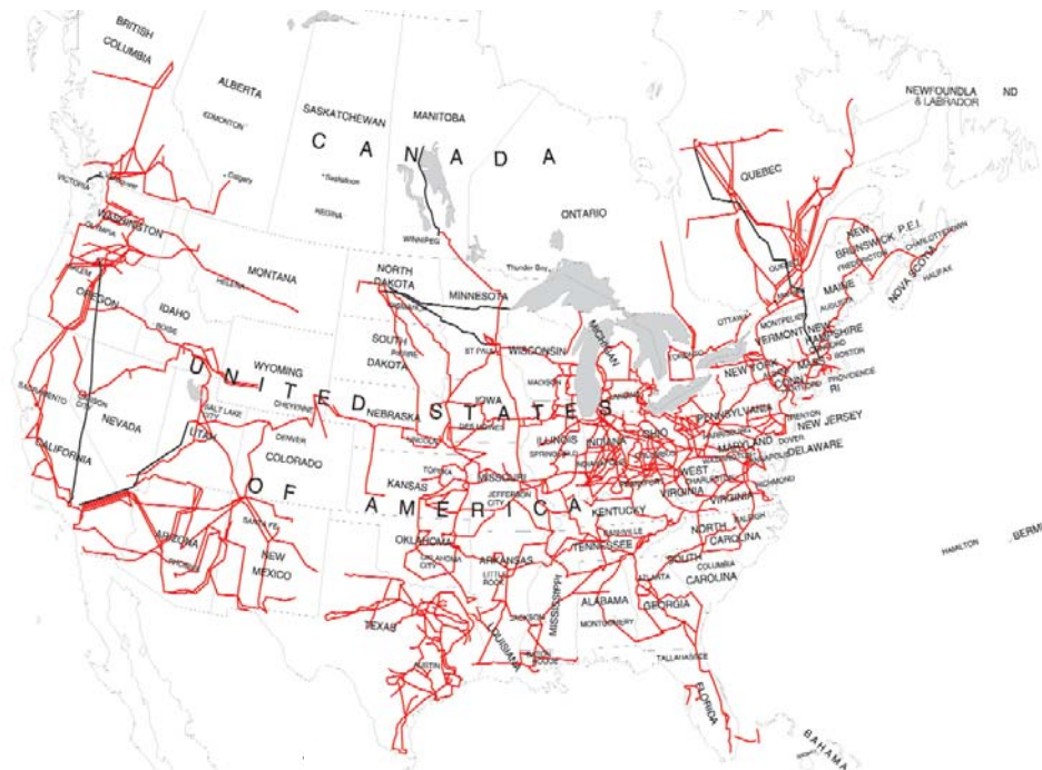
Carte, droits réservés ACÉ. Les lignes illustrées sont des lignes à 345 kV et plus. Il existe plusieurs interconnexions à moins de 345 kV entre le Canada et les É.-U., qui n'apparaissent pas sur cette carte.
