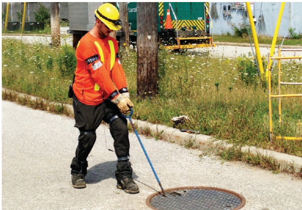
Employé de Toronto Hydro vêtu de la combinaison de saisie des mouvements IGS-180i conçu par Animazoo. Cette combinaison comprend 11 capteurs disposés sur le tronc et les membres du participant. Ceux-ci permettent de consigner ses mouvements de façon électronique lorsqu'il soulève les couvercles des chambres de raccordement au moyen des différents outils dont il dispose. Ces données peuvent ensuite être utilisées dans un programme de simulation afin d'évaluer la charge devant être soutenue par les articulations de l'épaule et la colonne vertébrale au moment du soulèvement des couvercles des chambres de raccordement. Photo reproduite avec l'aimable autorisation de Toronto Hydro.
