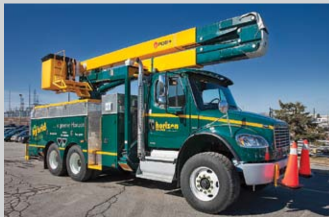
Le véhicule hybride et rechargeable à nacelle simple d'Horizon Utilities, qui combine les systèmes de propulsion classique et électrique pour permettre une meilleure économie de carburant et réduire les émissions.
