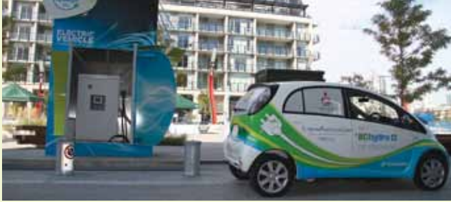
Démonstration par BC Hydro d'un poste de recharge rapide à courant continu de véhicules électriques.
